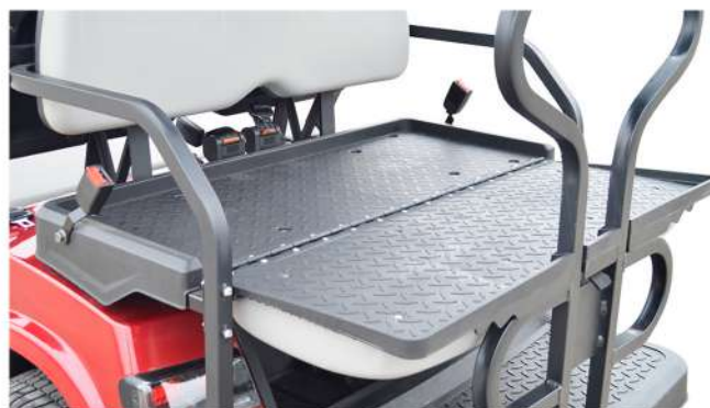
El kit Flip-flap que incorpora el Valencia 2+2 le permite transformar sus plazas posteriores en una práctica zona de carga en cuestión de segundos.
