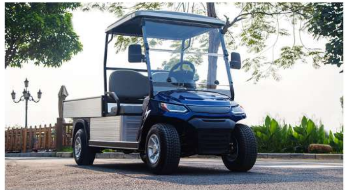
Teycars Baleares 2+Caja con arcón metálico de grandes dimensiones montado en su parte trasera y capacidad de carga de hasta 605 kg.
