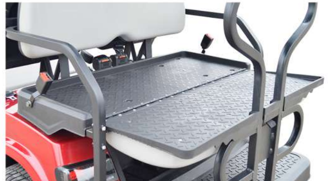
El kit Flip-flap que incorpora el Bleares 4+2 le permite transformar sus plazas posteriores en una práctica zona de carga en cuestión de segundos.
