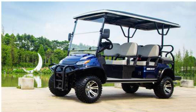
La variante Baleares all-road incorpora neumáticos multitaco y una suspensión elevada para trabajos en zonas con terreno suelto.
